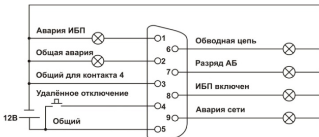
Рисунок 16 – Электрическая схема организации контроля и управления ИБП с электропитанием от источника постоянного тока напряжением +12 В
